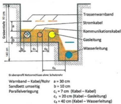
Bild 4 Gemeinsame Hausanschlussstrasse auf dem Privatgrundstück
