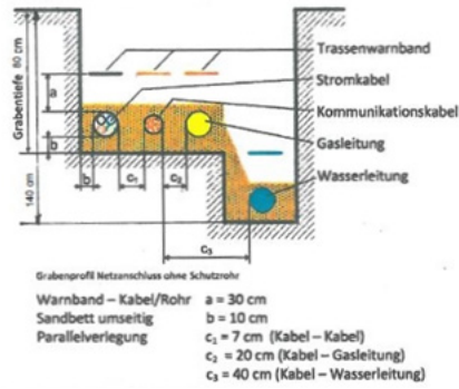
Bild 4 Gemeinsame Hausanschlusstrasse auf dem Privatgrundstück
